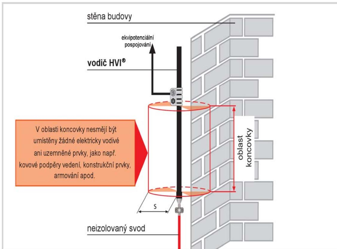
**Obr. A.4 – Připojení k vodiči HVI® II / III "Oddálené okružní vedení"**
