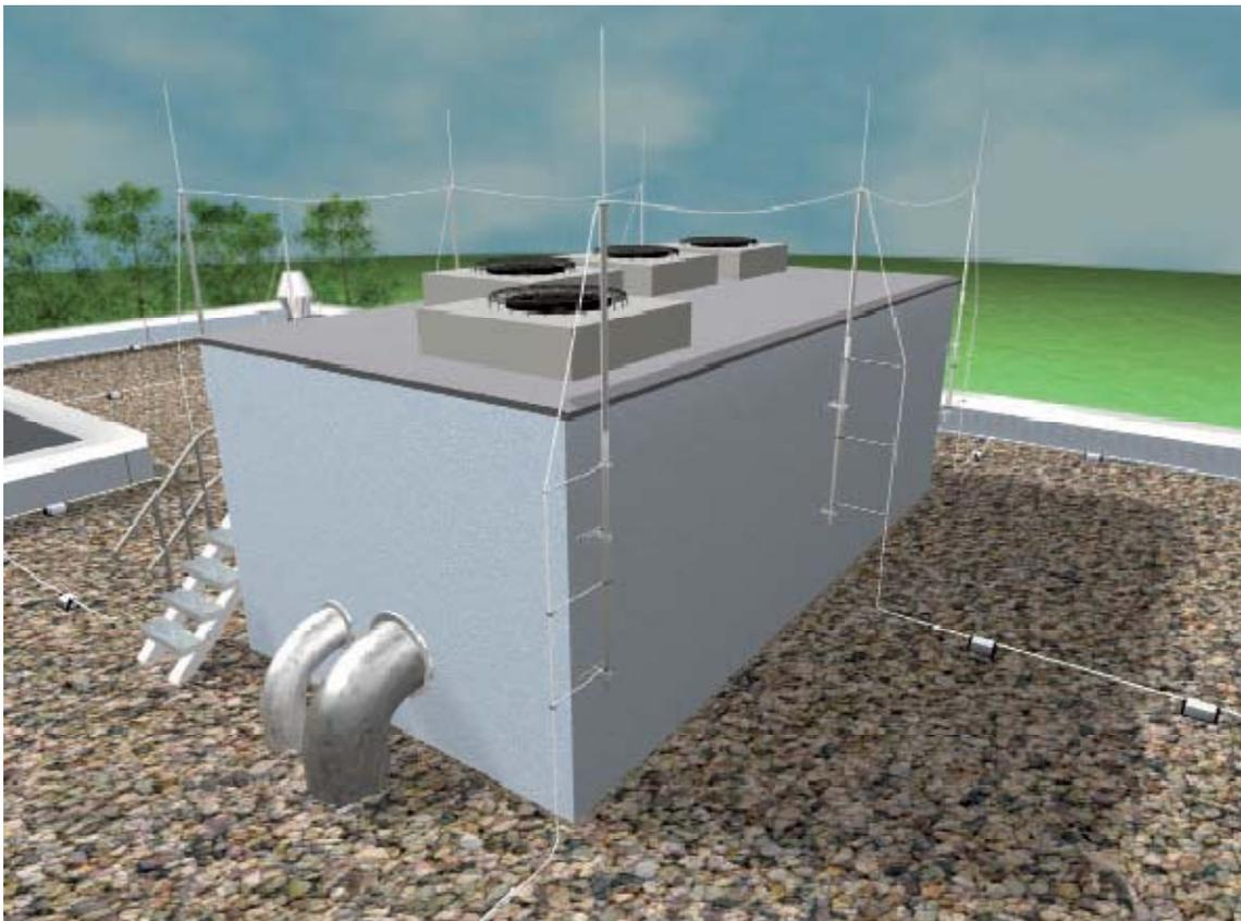
Systém izolovaných držáků DEHNiso je osvědčený systém s univerzální použitelností. Nabízí jednoduché a hospodárné řešení téměř pro všechny aplikace. Izolované držáky je možné používat jako vysoké podpěry pro oddálená jímací vedení nebo jako statické podpěry vysokých jímacích tyčí ( $R_d = 16 \text{ mm}$ ). K určení potřebné délky izolovaného držáku se používá koeficient  $km = 0,7$ , a proto je možné připojit jímací tyč nebo svod přímo k chráněnému zařízení.
