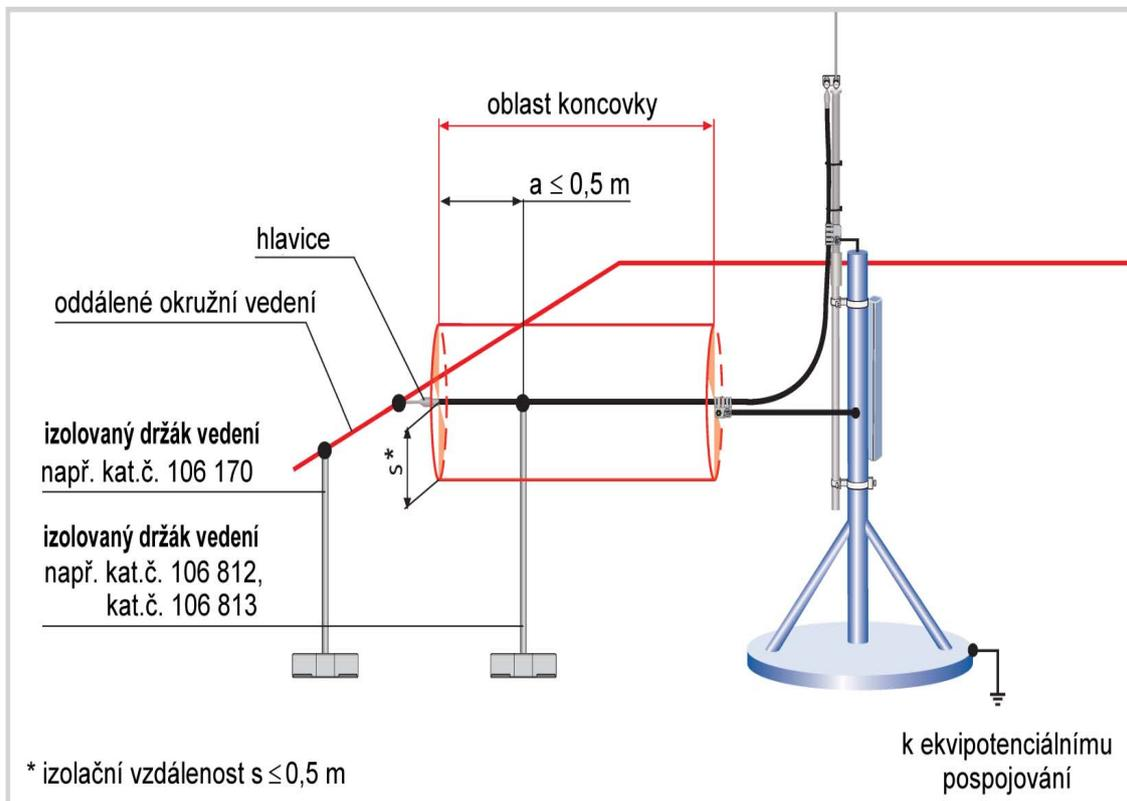
**Obr. A.5 – Přechod z vodiče HVI® II / III na neizolovaný svod; celé oplechování atiky je v ochranném prostoru jímače**
