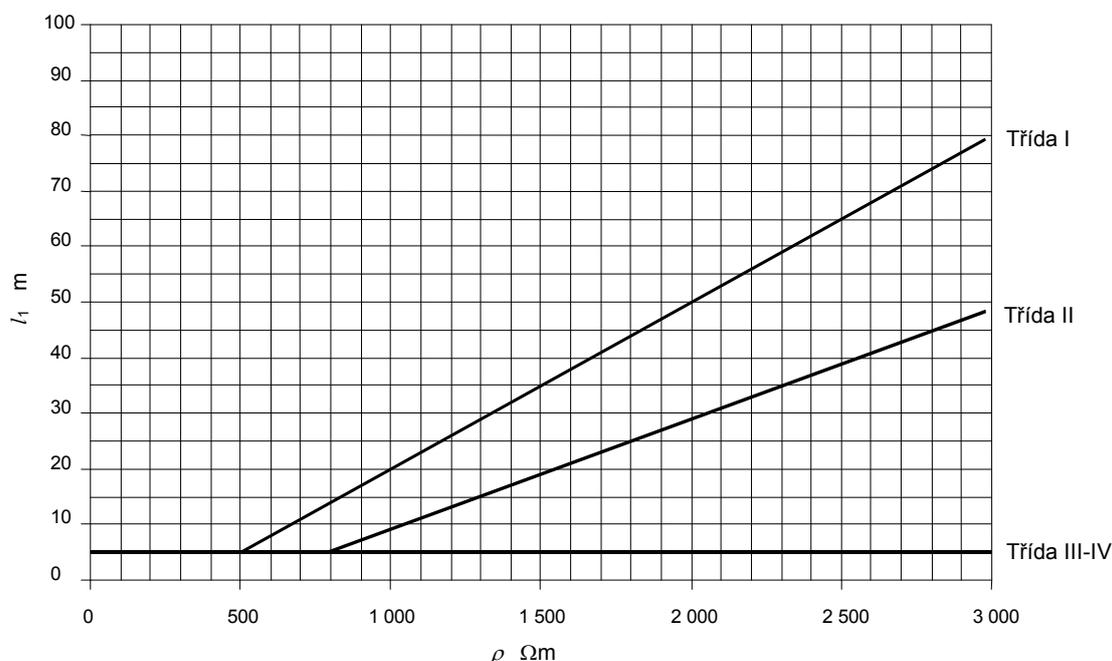
**POZNÁMKA** Třídy III a IV jsou nezávislé na rezistivitě půdy.
