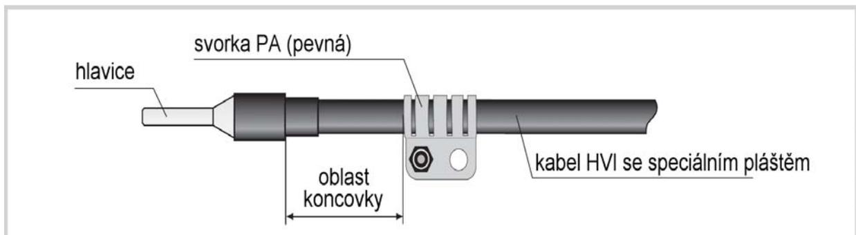
*Obr. A.3b – Vodič HVI® III, koncovka instalována na místě*
