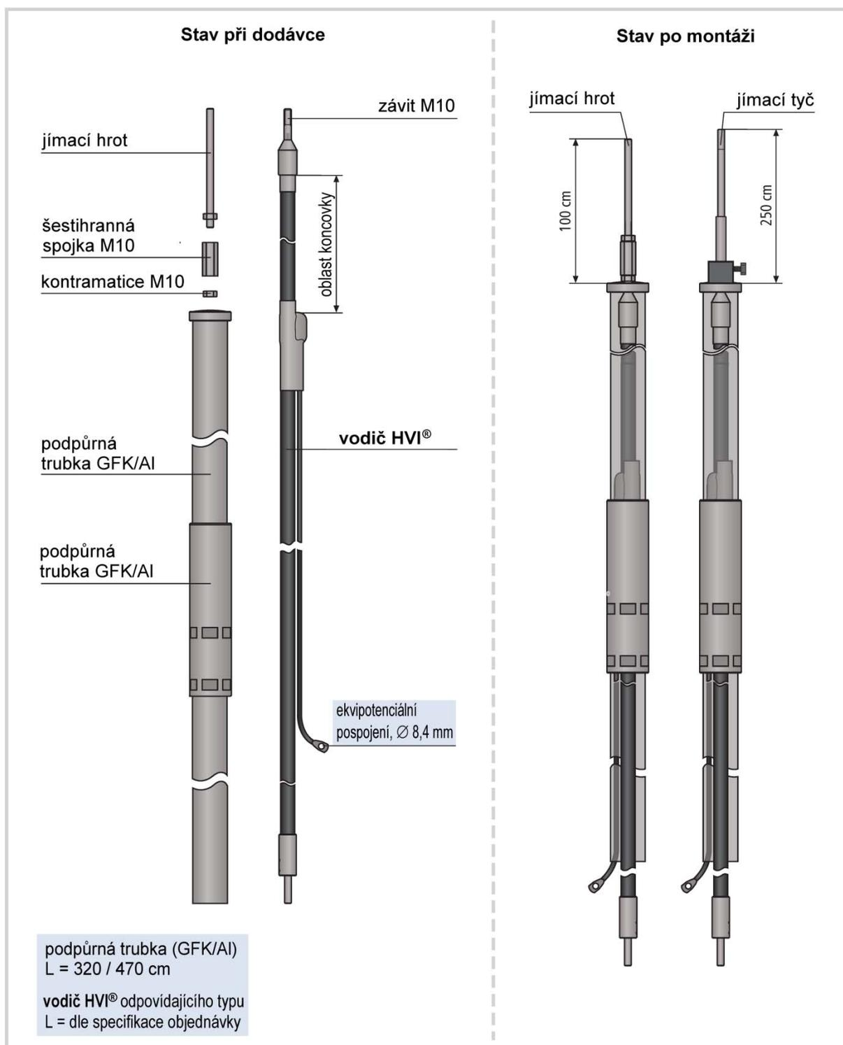
**Obr. A.7 znázorňuje typickou aplikaci stavebnice DEHNconductor System.**
